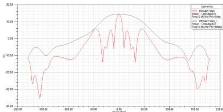
Fig. 18. Gain of 1×4 array at  $\phi=0\_deg$  (E-plane)&  $90\_deg$  (H-plane)
